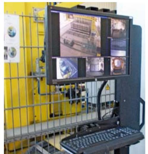
Produktionsbereiche läuft über einen LWL-Ring von ca. zehn km Länge. Die Darstellung läuft über ein „Gieß-TV“ (Foto) vor Ort mit Touch-Monitoren bis 40 Zoll Größe.
