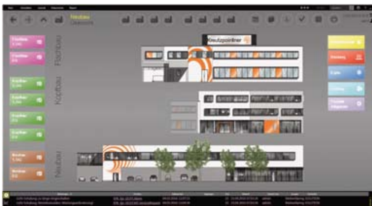
Starkes Projektierungsinstrument, welches das gesamte Spektrum von der Raumautomation bis hin zur Gebäudeleittechnik abdeckt: Die Software XAMControl von der Firma evon.
