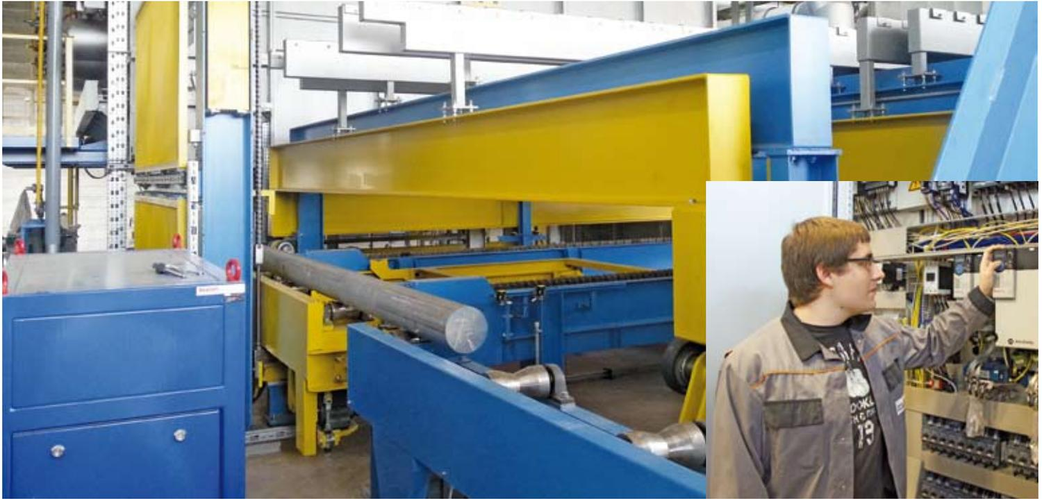
Vom EMSR-Engineering bis zur Endmontage elektrotechnisch ein „echter Kreuzpointner“ in Israel: Die Durchlauf-Homogenisierungsanlage von HPI gewährleistet höchste metallurgische Produktqualität, vom gegossenen Barren bis zum homogenisierten Bolzen (wie in der Bildmitte zu sehen).
