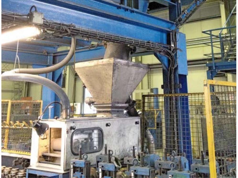
*Der Beschicker der Maschinenanlage bei der ASK am Standort Hart.*
