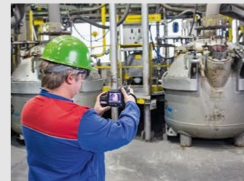
Markus Stockinger mit seiner Infrarotthermografie-Kamera bei Messungen an einem Tiegel für flüssiges Aluminium in Ranshofen.
