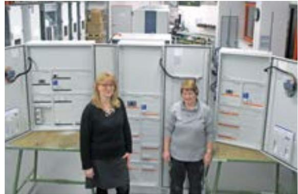
Für ein Werk der Siltronic AG in Singapur hat unser Freiburger Schaltanlagenbau im Januar diverse Leistungsverteiler geplant und angefertigt. Per Luftfracht ging es dann nach Asien. Für die Planung und das CAD (EPlan P8) war **Mandy Jentzsch** (links im Bild) verantwortlich: Für die Versorgung der Produktionsanlagen konzipierte sie Leistungsverteiler für Normal-Netz/NEA-Netz/USV-Netz.
